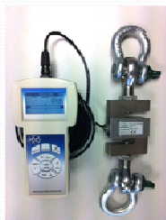
Δοκιμή Εξόλκευσης Πασσάλου.
