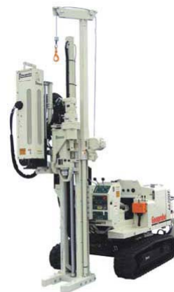
Γεωτρητικό Συγκρότημα με Αεροσφύρα για Εκτέλεση SPT
