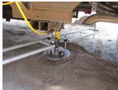
Δοκιμή στατικής φόρτισης μικρής κλίμακας
